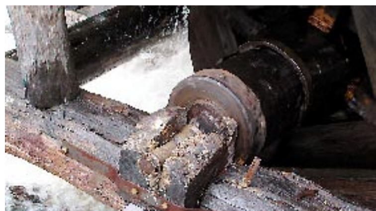
Gammalt och hållbart. Vevaxeln till vattenhjulet vilar i en "knota" från en tall. Och den håller fortfarande.
